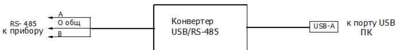
Рисунок 2 - Схема подключения конвертера USB/RS-485G
